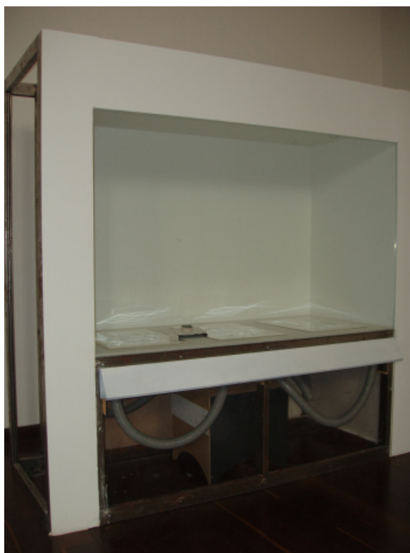
Imagen 5 Vitrina prototipo desarrollada para las pruebas de las condiciones medioambientales.
