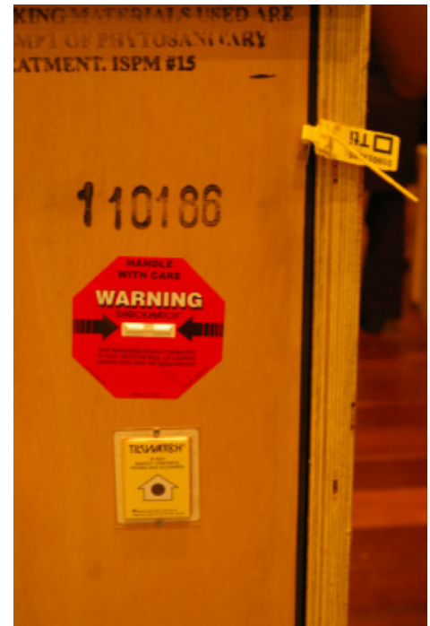
Imagen 13 Fotografía de los sensores de golpe y de movimiento de las cajas en las que se transportaron las piezas para la exposición Mutis al Natural .
