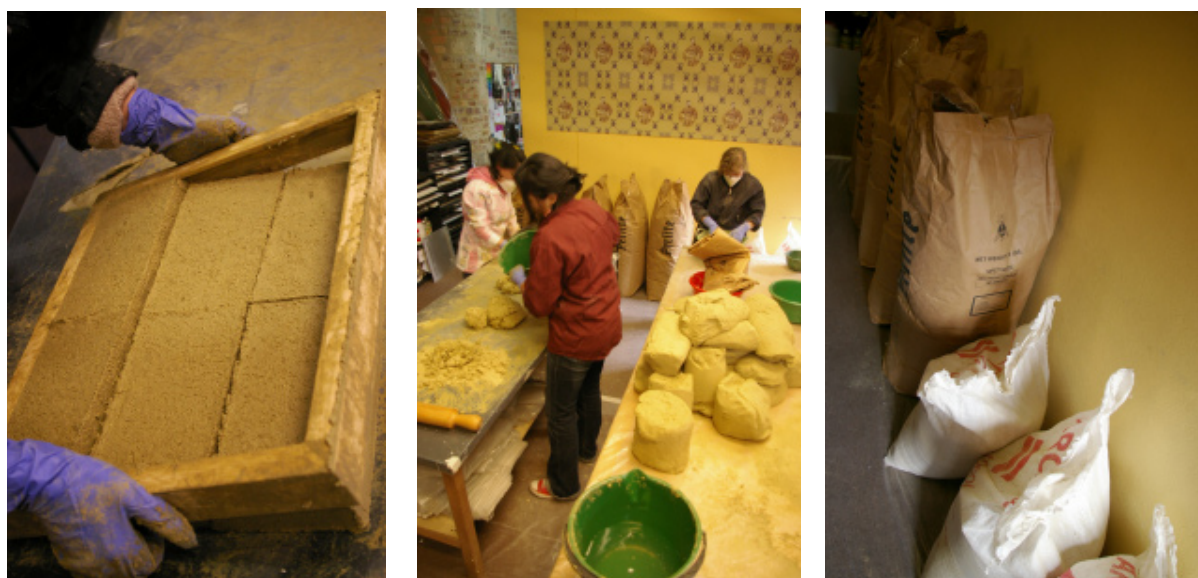
Imagen 7 Proceso de elaboración de las placas de bentonita y perlita expandida.
